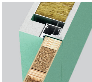
Bezfalcové štandard (otváranie von) - pravé dvere
