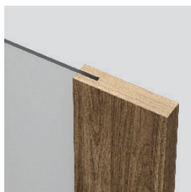
spojenie so sklom „na hranu“ bezpolodrážkové krídlo
