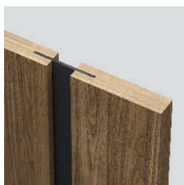
spojenie so sklom „na hranu“ bezpolodrážkové krídlo
